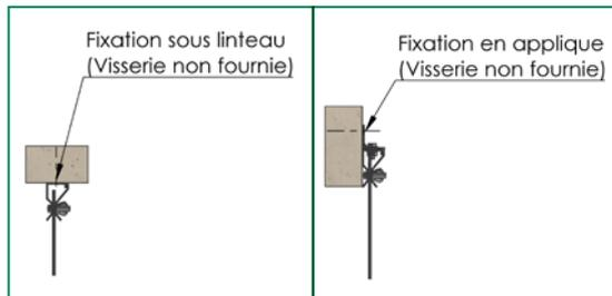
● Il est proposé en **acier galvanisé** d'épaisseur 2mm, en **inox 304L** ou en **inox 316L** pour les environnements les plus difficiles et hautement corrosifs, en **longueurs de 2m, 2m50 ou 3m** et pourra être coupé à **vos mesures**.
